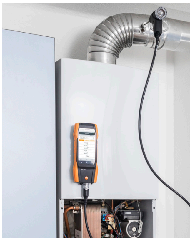
Per le operazioni di regolazione è indispensabile un analizzatore di combustione, come ad es. testo 300
